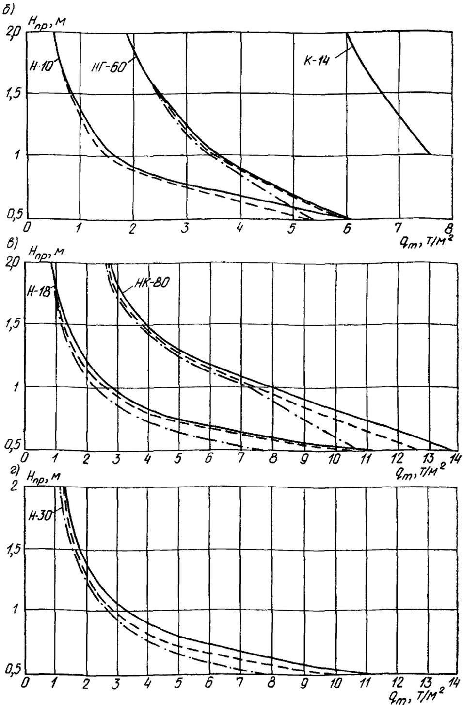
Рис. 41. Зависимость нормативного давления от транспорта  $q_{тр}^H$  от глубины заложения трубопровода  $H_{пр}$  при диаметре труб 110 мм (сплошные линии), при диаметре труб 50 мм (пунктирные линии) и при диаметре труб 1200 мм (штрихпунктирных линий): а — от нагрузок при  $H_{пр}$  от 2 до 9 м; б — от нагрузок HГ-60 при  $H_{пр}$  от 0,5 до 2 м; в — от нагрузок H-18 и НК-80 при  $H_{пр}$  от 0,5 до 2 м; г — от нагрузки H-30 при  $H_{пр}$  от 0,5 до 2 м
