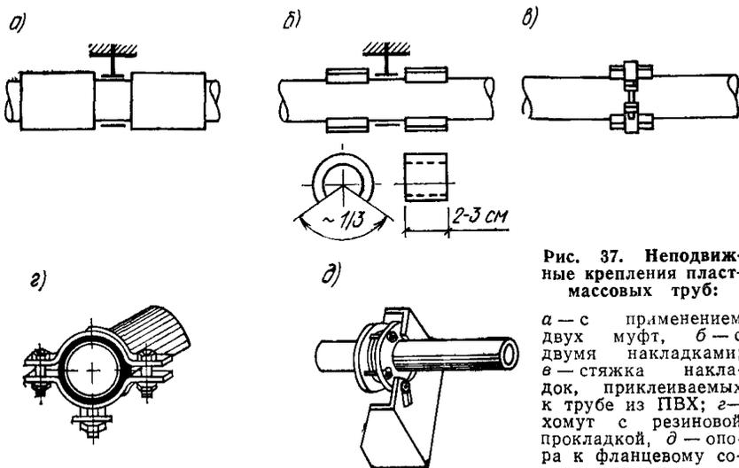
Рис. 37. Неподвижные крепления пластмассовых труб:
