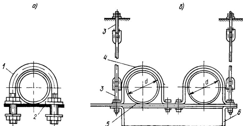
Рис. 36. Подвижные крепления пластмассовых труб с применением:
