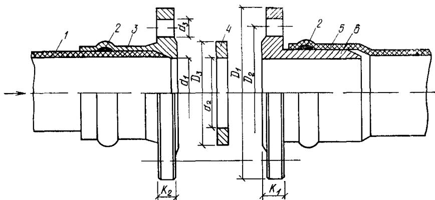
Рис. 18. Фланцевое соединение раструбных труб из ПВХ:
