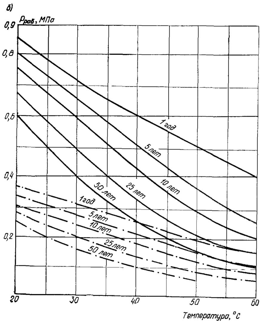
Рис. 4. Зависимость рабочего давления  $P_{\text{раб}}$  от температуры и срока службы трубопровода для труб из ПП типов Т (—), С (---) и Л (-.-.-)
