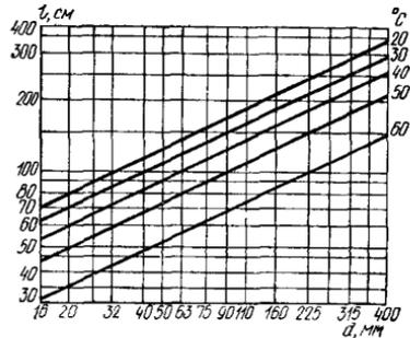
Рис. 33. Расстояния между креплениями на горизонтальных участках трубопровода из ПВХ типов Л, С и Т
