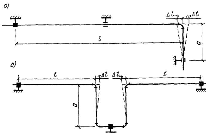
**Рис. 24. Изогнутые участки трубопровода, предназначенные для компенсации температурных изменений длин труб**
