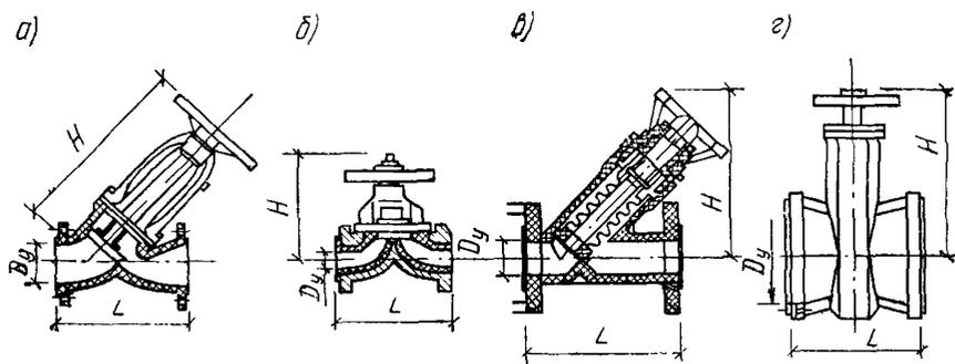
Рис. 19. Запорная арматура для коррозионных и агрессивных веществ:
