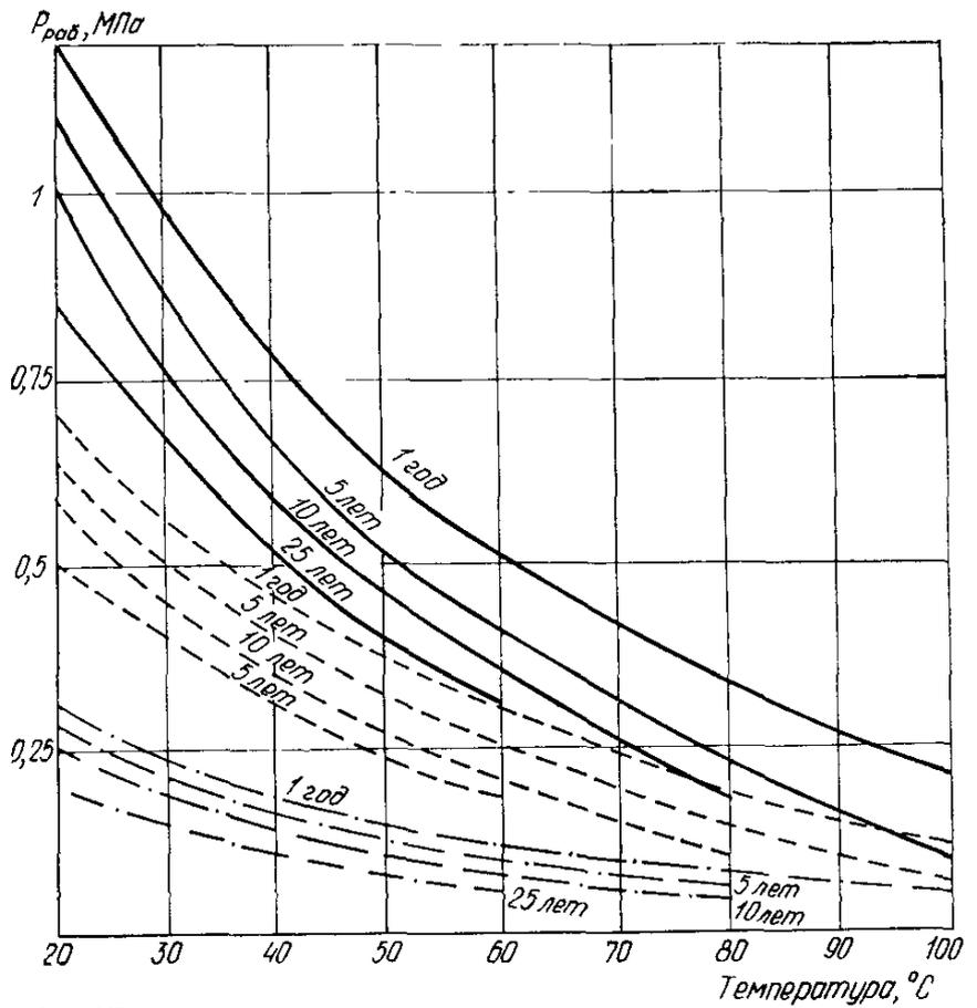
Рис. 5. Зависимость рабочего давления  $P_{\text{раб}}$  от температуры и срока службы трубопровода для труб из ПВХ типов ОТ (—), Т (---), С (-.-.-) и СЛ (-)
