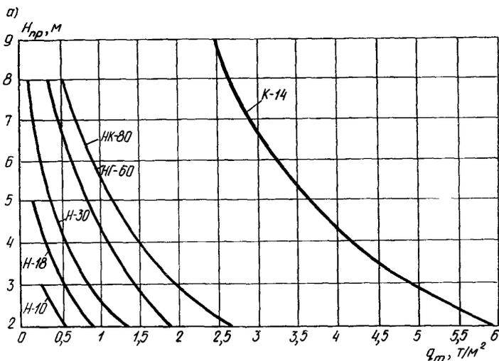
мобильного и гусеничного транспорта, передаваемое на трубопровод через грунт, определяемое для нагрузок Н-18, Н-30, НГ-60 и НК-80 по рис. 41 в зависимости от приведенной глубины заложения трубопровода, которая определяется по формуле
