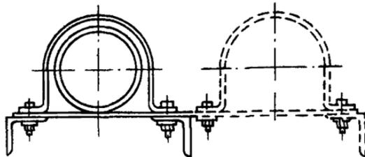
Рис. 29. К выбору сечения уголков под сплошное основание
