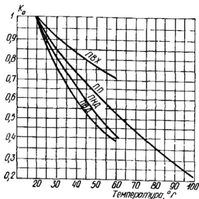
Рис. 7. Зависимость коэффициента  $K_0$  от температуры
