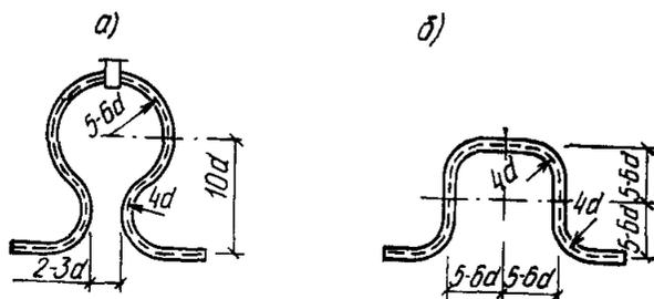
**Рис. 28. Компенсаторы для трубопроводов из ПВХ:**
