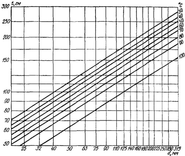
полученных по графикам на рис. 30—32, на коэффициенты соответственно 0,9; 0,8 и 0,7. Для труб из ПВХ типа ОТ расстояния между креплениями следует увеличивать путем умножения величин, полученных по графику на рис. 33, на коэффициент 1,1.
