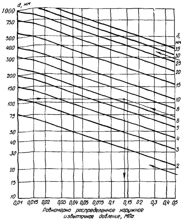
Рис. 10. График прочности труб из ПНД при вакууме
