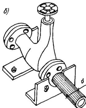
Рис. 35. Крепление арматуры с помощью опоры для труб диаметром: а — до 63; б — свыше 63
