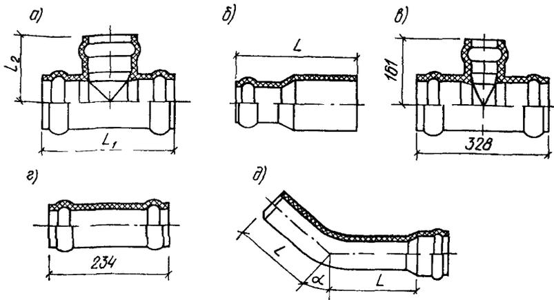
Рис. 16. Соединительные детали из ПВХ для раструбных труб:
