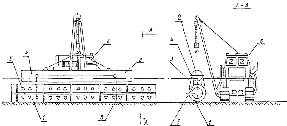
Рис. 9.1. Схема навески разгружающих понтонов на трубопровод:
