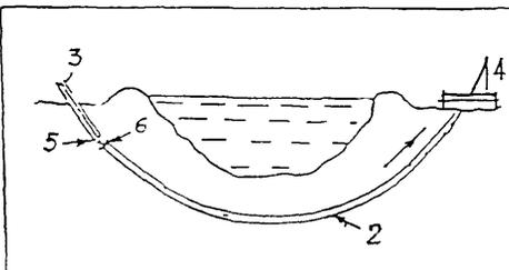
Этап 3. Протаскивание трубопровода за расширителем к буровой установке
