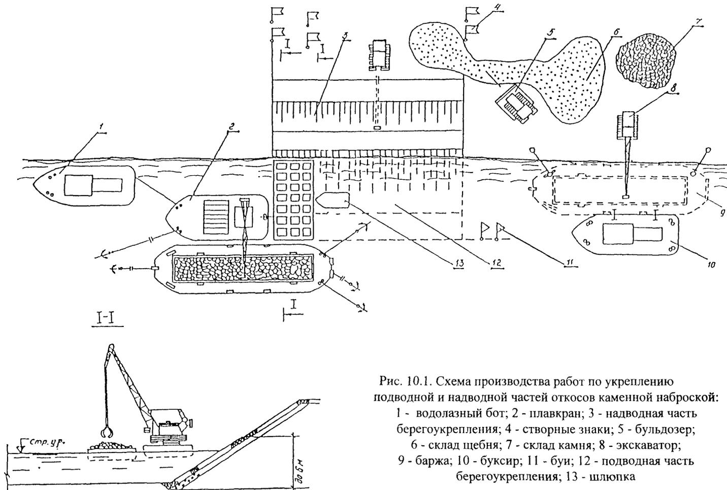
Рис. 10.1. Схема производства работ по укреплению подводной и надводной частей откосов каменной наброской:
