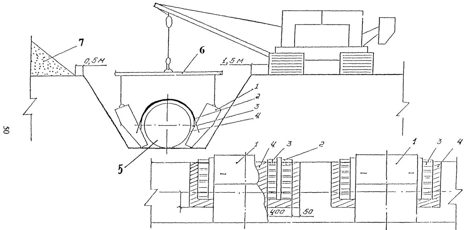
Рис. 7.1. Схема балансировки трубопровода утяжелителями УБО:
