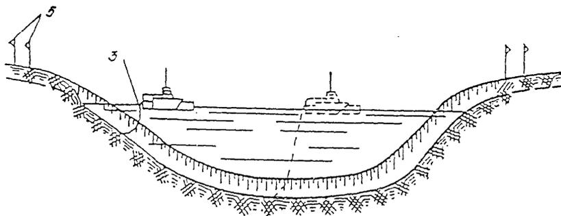
Рис. 9.2. Схема прокладки тягового троса с плавучей площадки:
