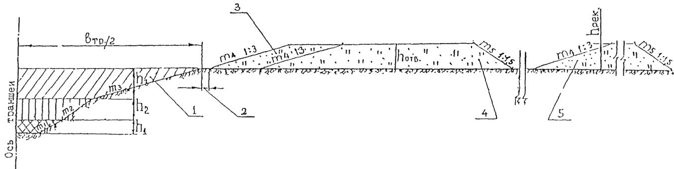
Рис. 4.2. Расположение отвалов извлеченного грунта в границах рабочей полосы:
