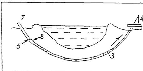
Этап 4. Гидравлическое испытание трубопровода в скважине
