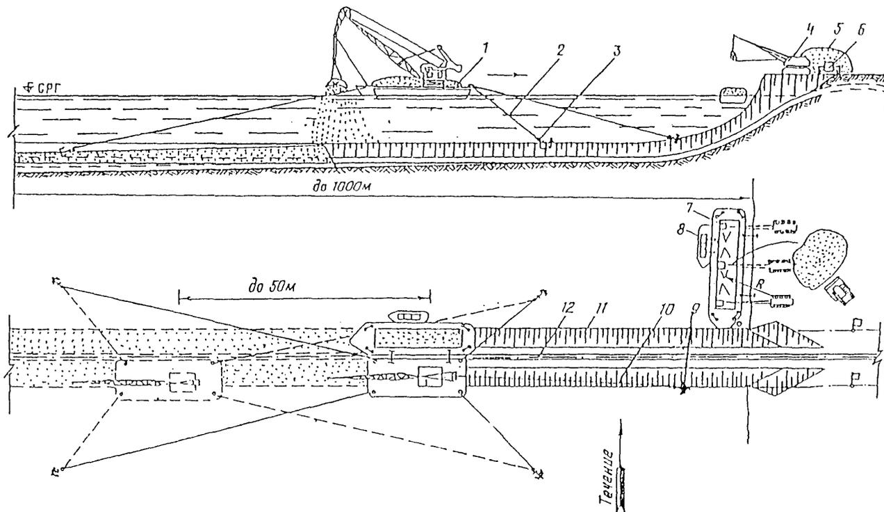
Рис. 4.5. Схема засыпки подводной траншеи с плавучей площадки:
