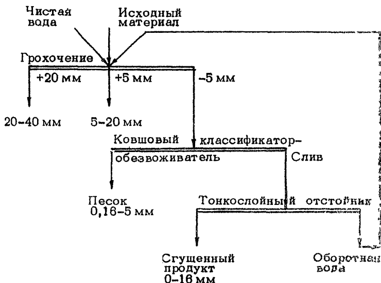
Рис. 6. Технологическая схема "мокрого" обогащения отсева дробления
