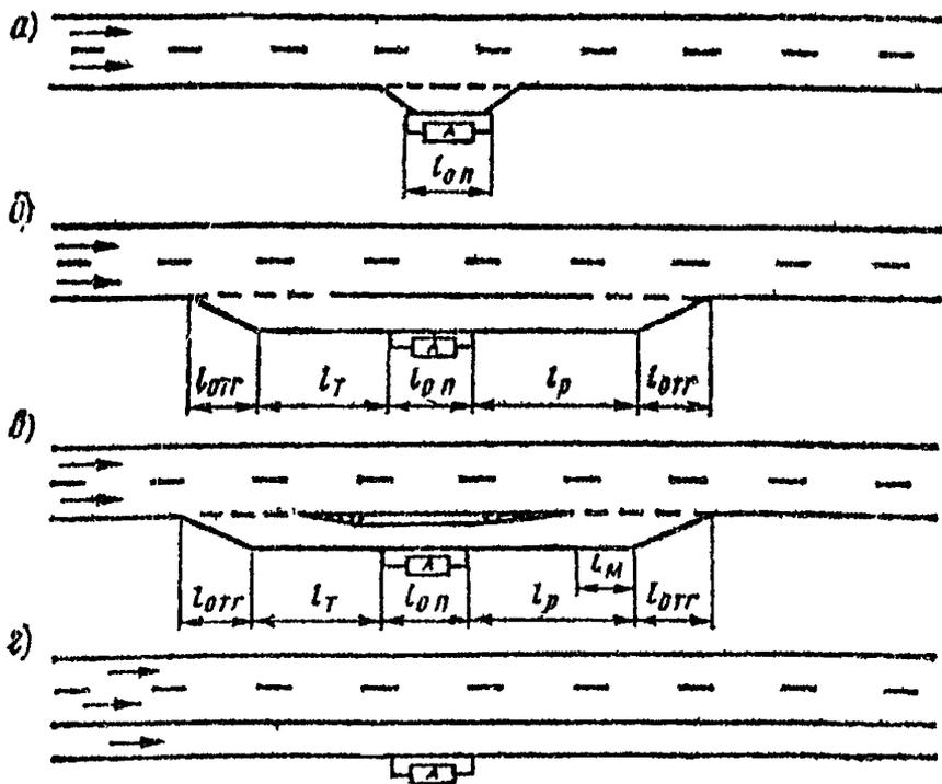
Рис. 131 Варианты планировочных решений в зоне автобусных остановок для отделения маршрутных автобусов от потоков автомобилей:
