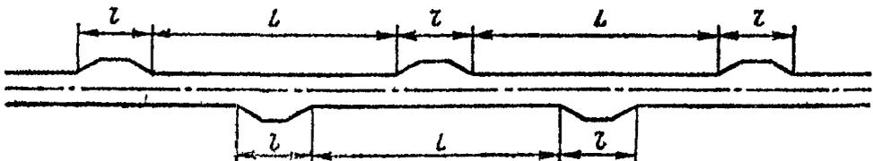
Рис 136 Расположение дополнительных обгонных полос I в плане на участке дороги с интенсивным движением тракторов
