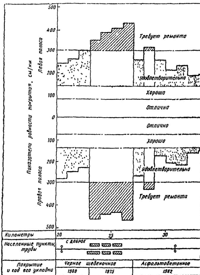
Рис 2.6 Линейный график ровности
