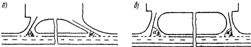
Рис 14.3 Схемы подъездов к сооружениям обслуживания, располагаемым в придорожной полосе
