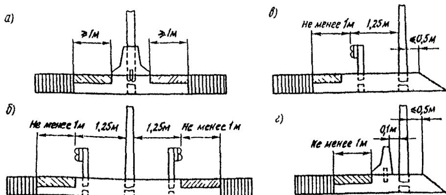
Рис 15.2. Схема установки опор освещения и ограждения на разделительной полосе (*а*, *б*) и обочине (*в*, *г*)
