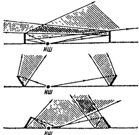
Рис 165 Ограждение звука от барьеров при различном их наклоне
