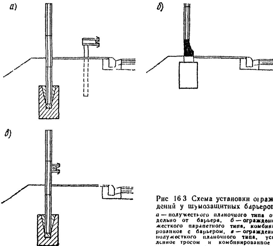
Рис 16 3 Схема установки ограждений у шумозащитных барьеров: а — полужесткого планочного типа отдельно от барьера, б — ограждение жесткого парапетного типа, комбинированное с барьером, в — ограждение полужесткого планочного типа, усиленное тросом и комбинированное с барьером
