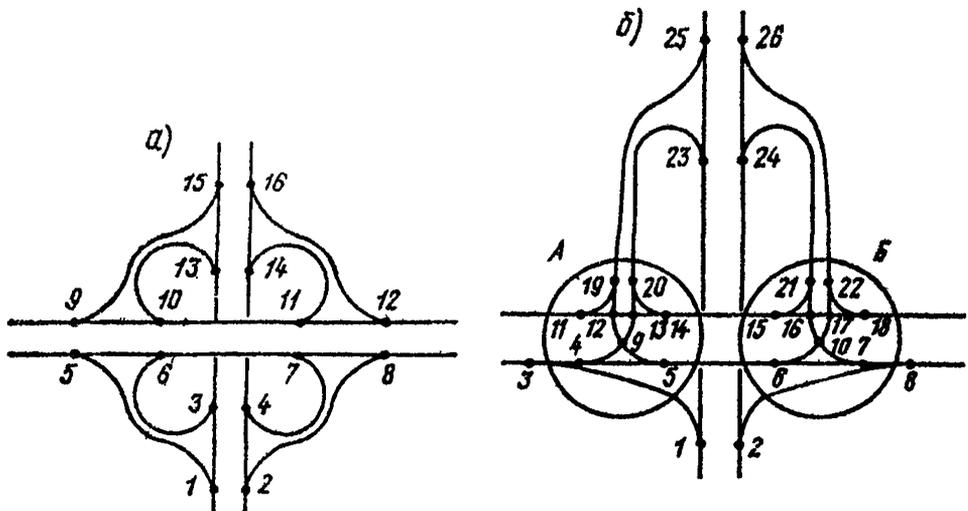
Рис. 1.5. Схема конфликтных точек на транспортных развязках: а — полная транспортная развязка (2, 3, 5, 7, 10, 14, 12, 15 — точки разделения потоков; 1, 8, 9, 16, 4, 6, 11, 13 — точки слияния потоков); б — неполная транспортная развязка (А и В — узлы, оцениваемые как пересечения в одном уровне по табл. 1.13, 1, 2, 3, 8, 23, 24, 25, 26 — точки, оцениваемые по табл. 1.18)
