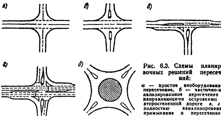
Рис. 6.3. Схемы планировочных решений пересечений:
