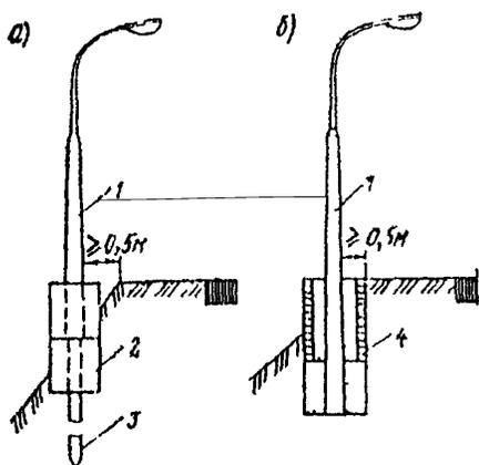
Рис 15.1. Схемы заделки в грунт опор освещения:
