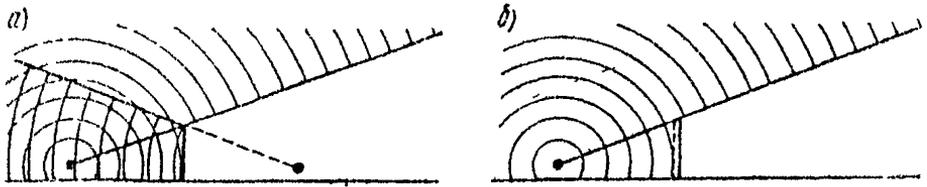
Рис. 164. Схема распространения шума при устройстве барьера
