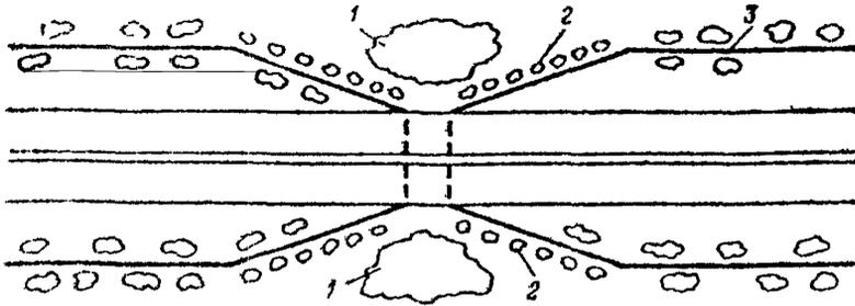
Рис. 16.11 Схема устройства перехода для диких животных.
