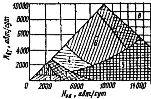
Рис 6 2. Номограмма для выбора типа планировочных решений пересечений.
