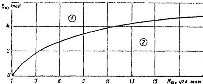
Рис. 3.3 График для определения зрительной плавности дороги
