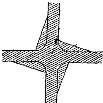
633 Для улучшения условий движения на пересечениях с большим количеством автомобилей, поворачивающих направо, целесообразно применять уширенные несимметричные пересечения (рис. 68), имеющие в 1,5 раза большую пропускную способность, чем обычные пересечения.
