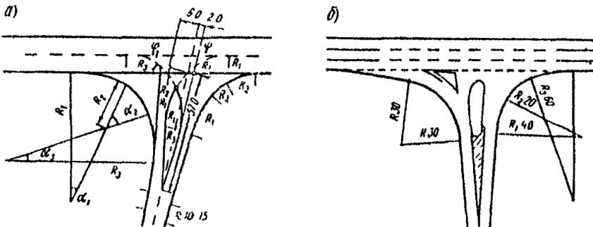
Рис 6 12 Расположение островков на второстепенной дороге
