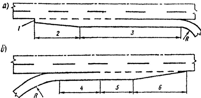
Рис 77 Элементы полос торможения (а) и разгона (б).
