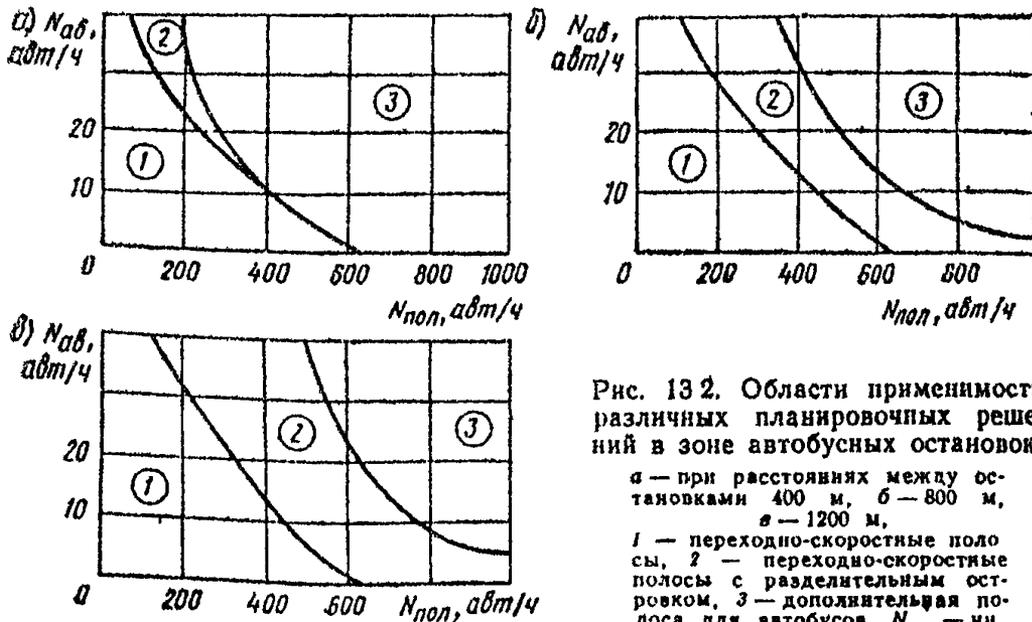
Рис. 132. Области применимости различных планировочных решений в зоне автобусных остановок.
