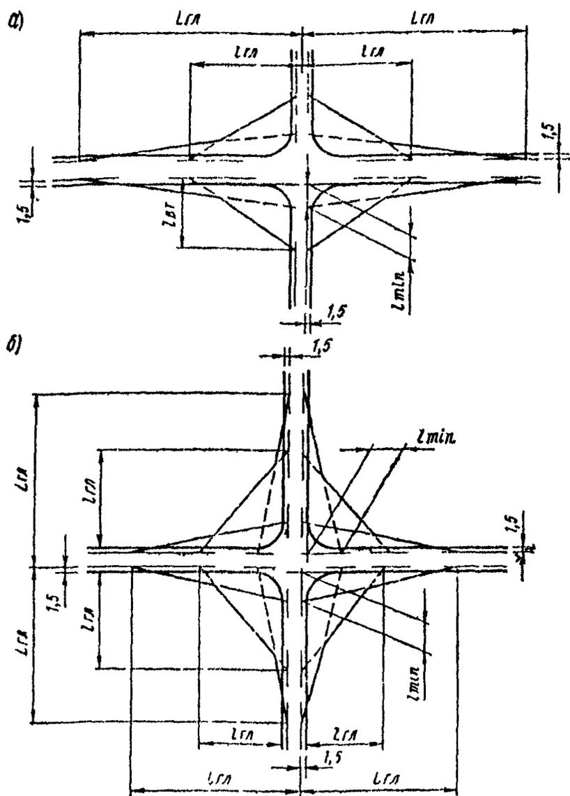
Рис 6.1 Схемы определения видимости на пересечениях в одном уровне
