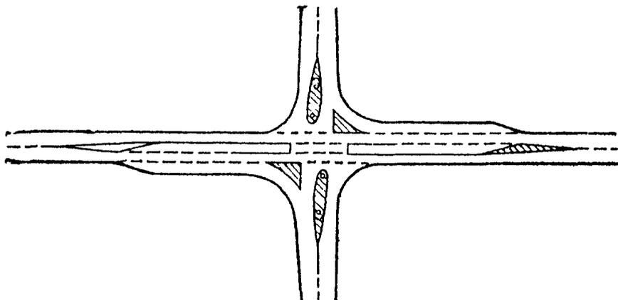
Рис 6.15 Выделение островков на проезжей части разметкой
