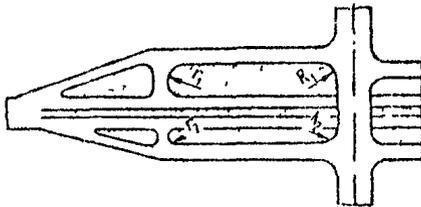
Рис 76 Схема планировки развязки обжатый «клеверный лист»
