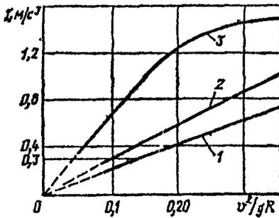
Рис. 4.2 График для определения расчетного нарастания центростремительного ускорения
