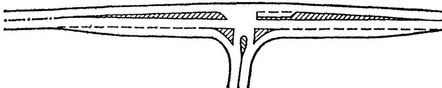
Рис 6.10 Направляющие островки на примыкании в одном уровне
