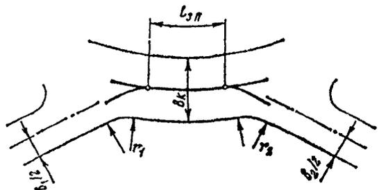
Рис. 618 Схема к расчету диаметра центрального островка на кольцевом пересечении.
