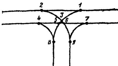
Рис. 14 Схема конфликтных точек на примыканиях автомобильных дорог в одном уровне
