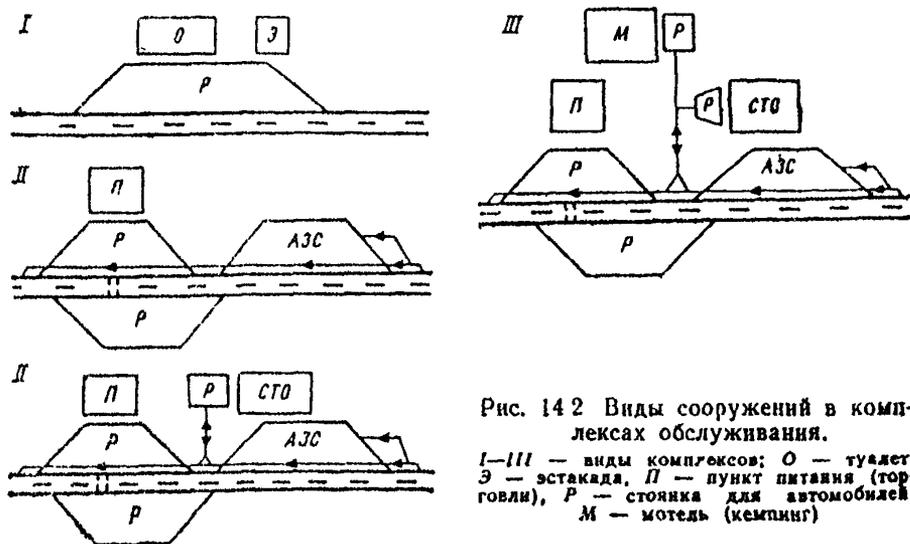
Рис. 14.2 Виды сооружений в комплексах обслуживания.
