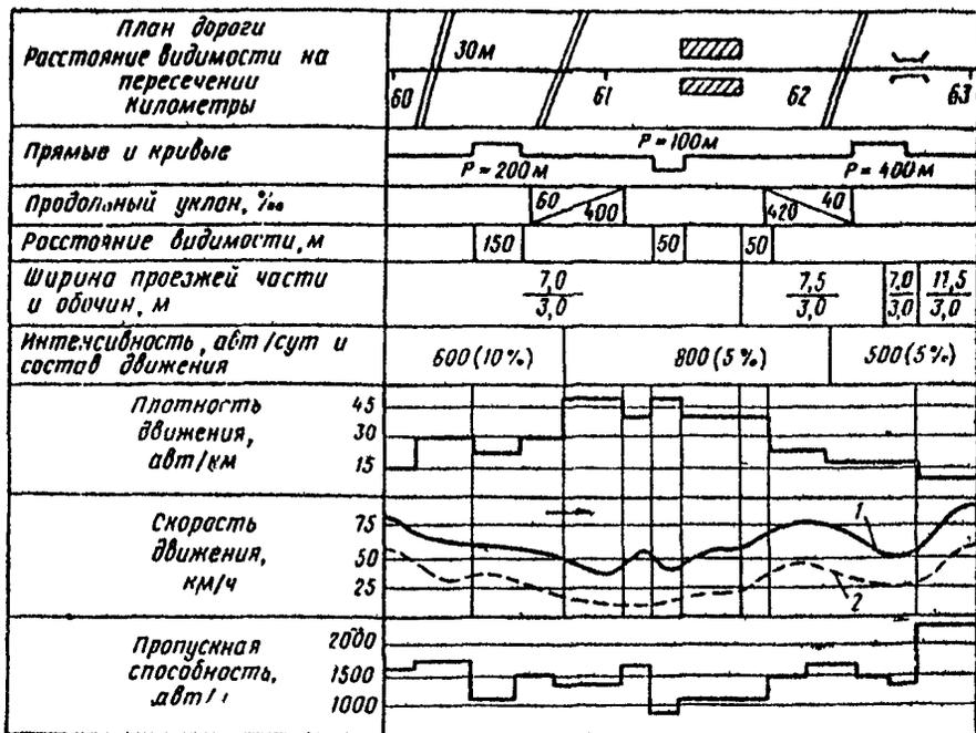
Рис 22. График изменения режима движения по длине дороги: 1 — легкие автомобили, 2 — грузовые автомобили, в скобках указана доля тяжелых грузовых автомобилей в потоке
