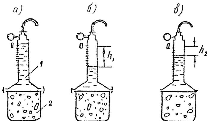
Рис. 5. Схема отсчетов при определении воздухоудержания в бетонной смеси:
