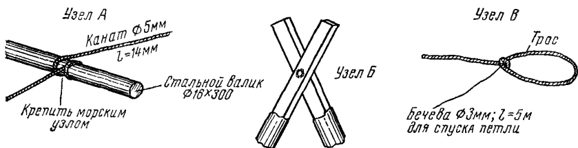
6.36. Способ установки опор при помощи «падающей стрелы»
