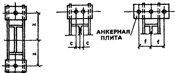
Рис.19. Схема расположения болтов для крепления стальных колонн решетчатого типа
