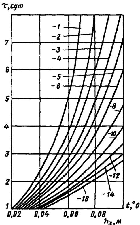
Рис. 3. Длительность замораживания осадка в зависимости от толщины слоя и среднесуточной температуры воздуха
