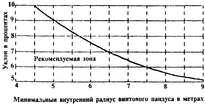
График 2. Зависимость внутреннего радиуса винтового пандуса от величины его уклона
