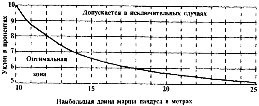
График 1. Зависимость длины марша пандуса от величины его уклона
