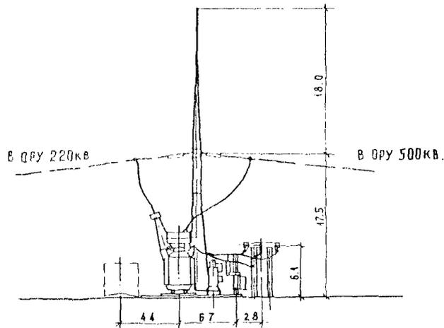
УСТАНОВОЧНЫЕ ЧЕРТЕЖИ ОДНОФАЗНОГО АВТОТРАНСФОРМАТОРА
