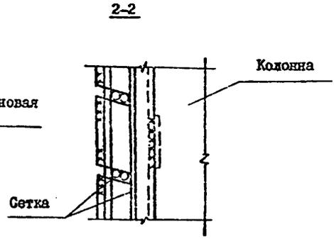
Узел крепления деревянной стенки к колонне
