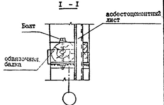
Узел крепления стенки из рулонных изделий к колонне
