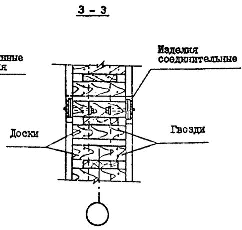
Узел крепления железобетонной
